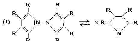
Wir versuchten deshalb, das Dimerisationsprodukt durch Umsetzung des Kaliumsalzes von 2,3,4,5-Tetraphenylpyrol mit Chlor in ätherischer Lösung unter Stickstoff-Atmosphäre direkt darzustellen. Dabei wurden Präparate erhalten, welche 1,1'-Bis-(2,3,4,5-tetraphenyl-pyrryl) zu 60–80 % angereichert enthielten. Das reine Dimerisationsprodukt ließ sich bisher nicht in Substanz isolieren.
